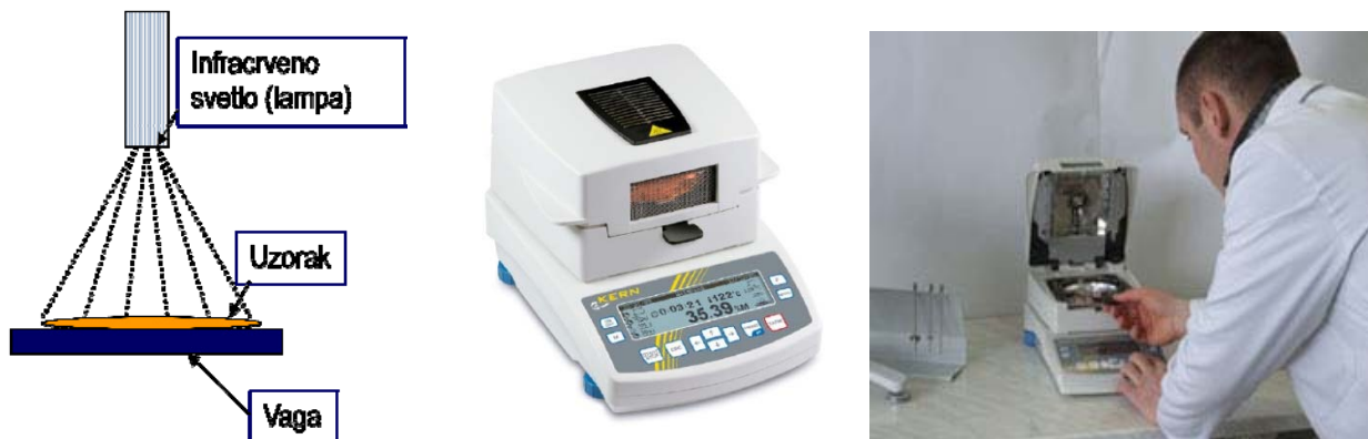
Slika 3.2. Infracrveno merilo vlažnosti biomaterijala
